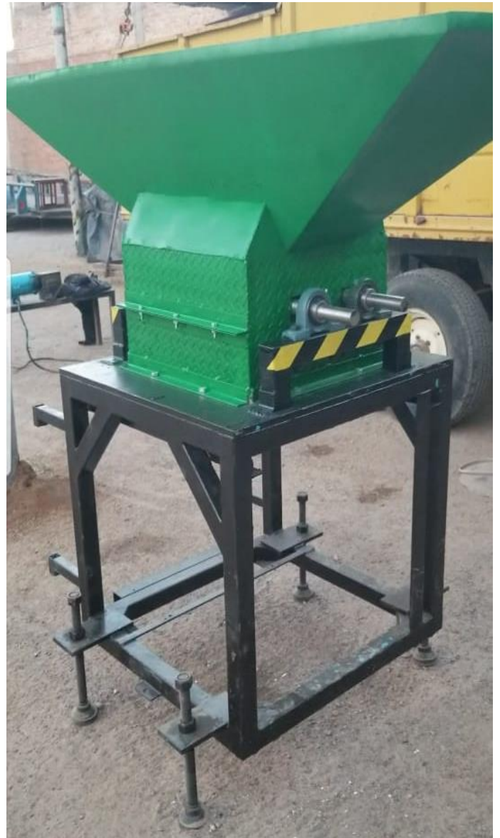
Figura 68 finalización de máquina trituradora de botellas de PET construida y ubicada en la empresa PROMAS Aguascalientes.
