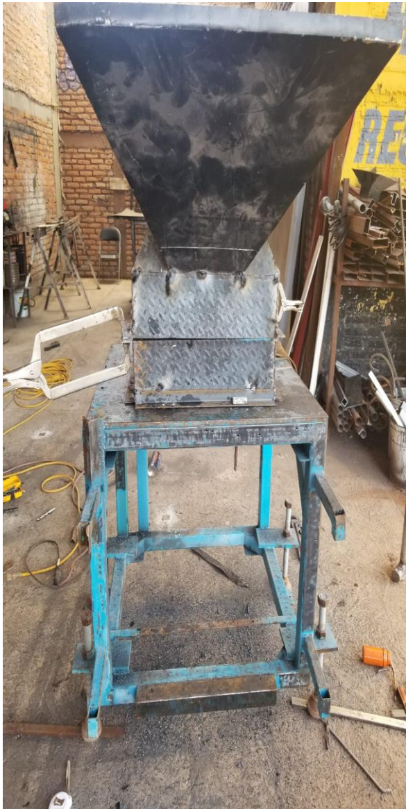
Figura 67 Máquina trituradora en construcción.
