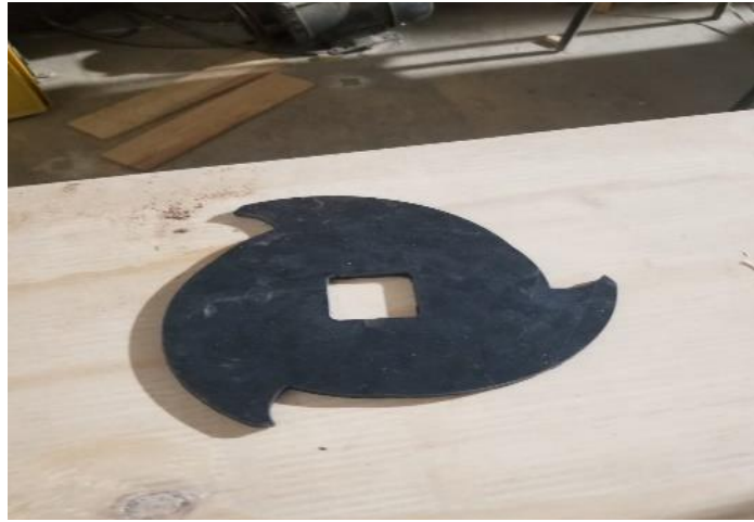
Figura 49 Navaja de lámina antiderrapante cortada con plasma
