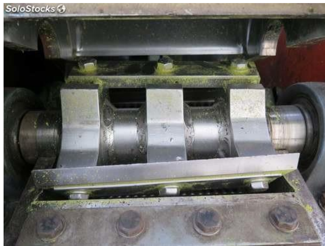
Figura 21 Molino de cuchillas, utilizado especialmente para moler la caña de azúcar
