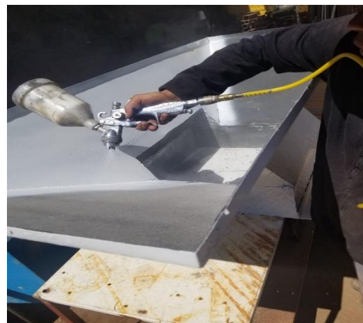
Figura 52 Aplicación de fondo blanco en la parte interna
