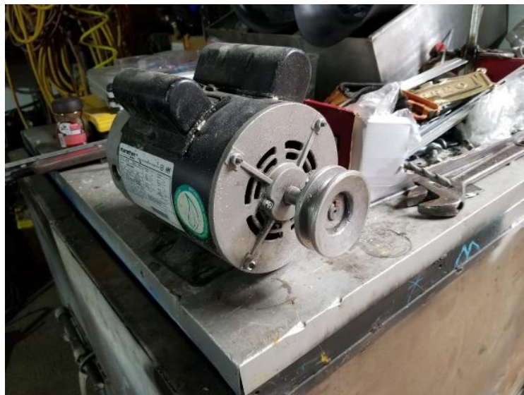
Figura 46 Motor eléctrico, cuenta con una potencia de 1.0 caballos de fuerza
