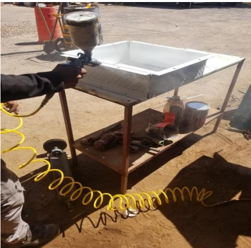
Figura 53 Aplicación de fondo para la caja de cuchillas
